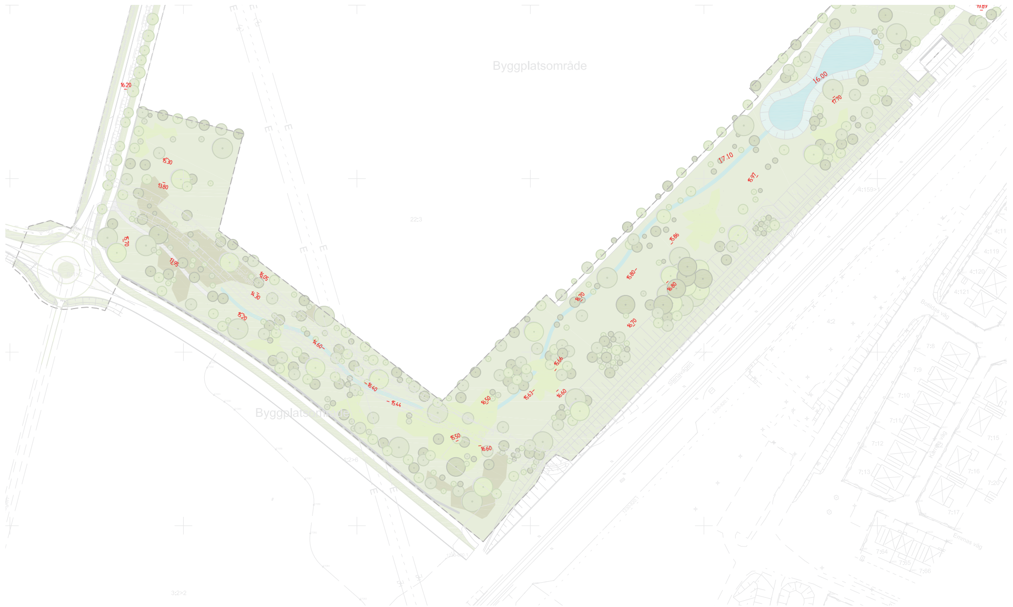
Figur 23. Förprojekterad höjdsättning enligt Skyfallsanalys, Västerstad, slutrapport 2020-09-29. Enligt utredningen kommer höjdsättningen är klara 100-års regn med klimatfaktor. Norra delen (föregående sida) och södra delen av planområdet (denna sida).
